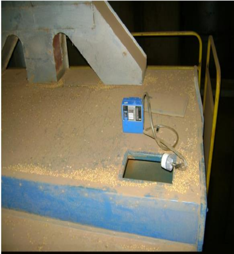
Figura 68: Local de realização da coleta de pó na máquina de limpeza
