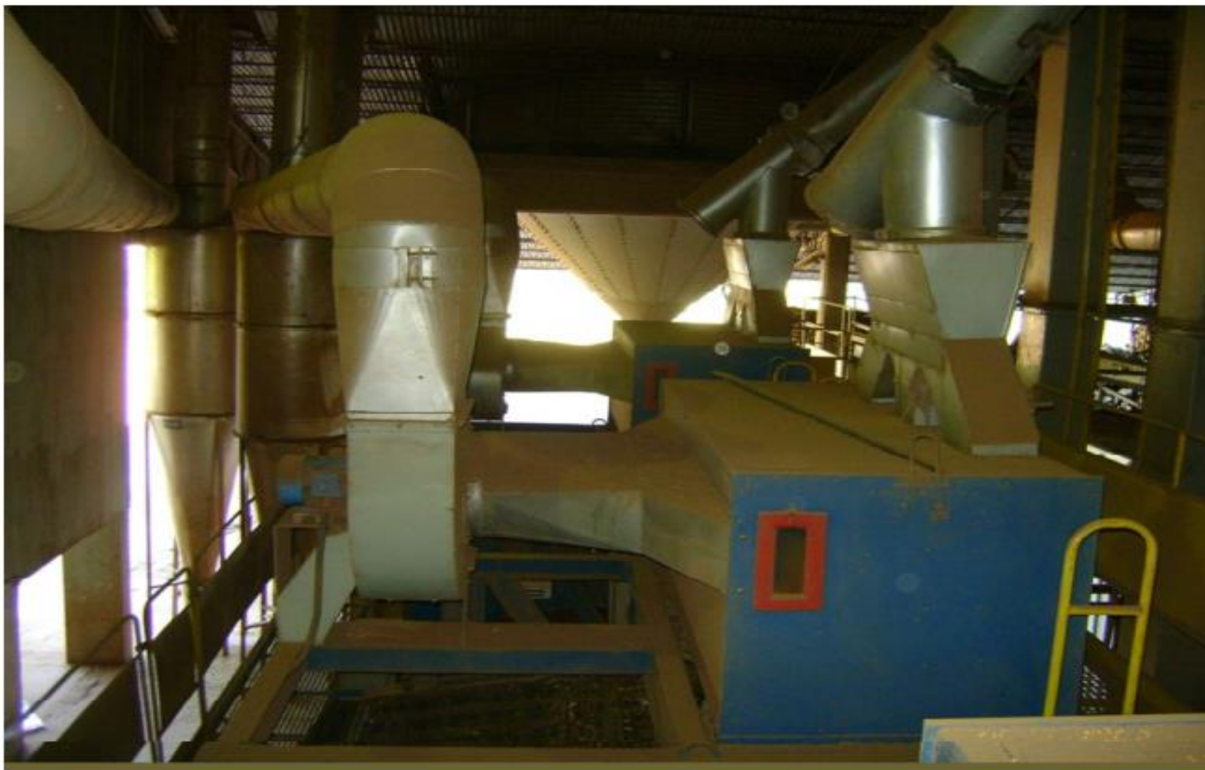
Figura 34: Máquinas de limpeza providas de captore de pós (MARIN, 2005)
