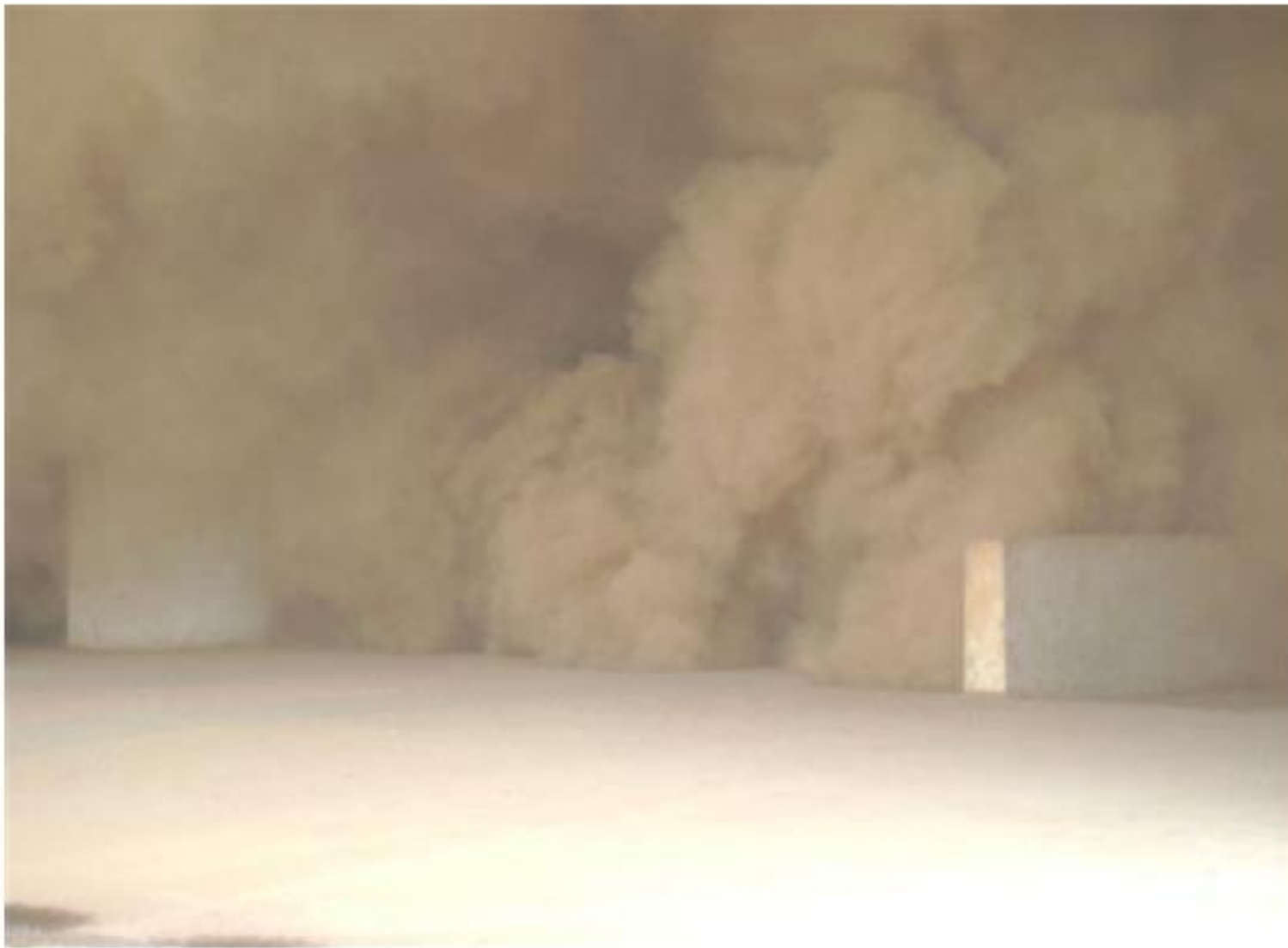
Figura 24: Moega sem captore de pó no momento da descarga de soja com tombador
